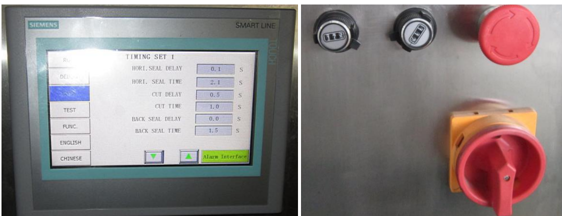
Pantalla Táctil Alemana_Germany Siemens touch screen Regulador de Resistencia _ resistance regulator
