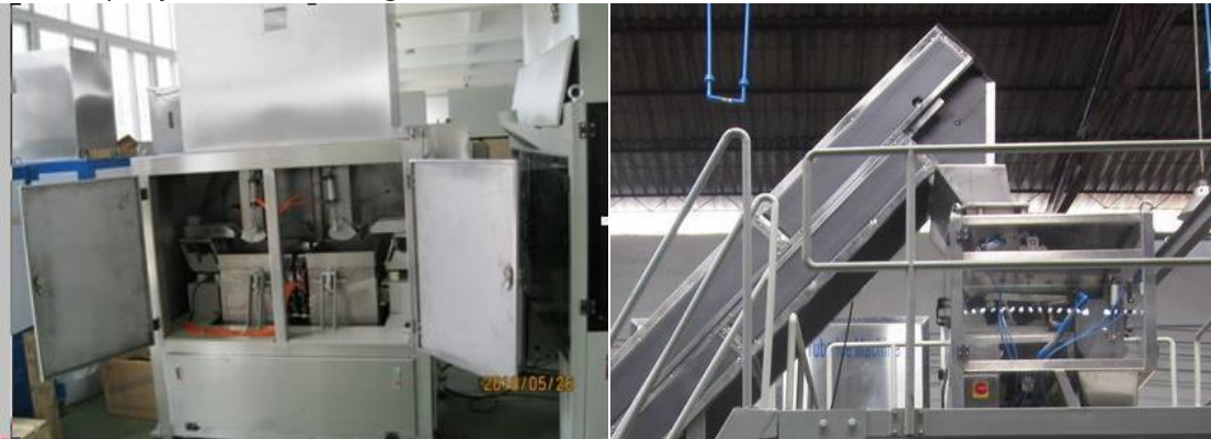
Dimensiones Pesadora de dos Cabezas: 1300*1000*2300mm
